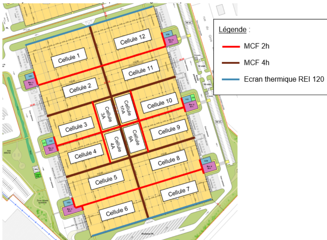
Répartition des murs coupe-feu du bâtiment LOG
